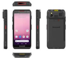
Der ScanPal EDA56 ist einer der mobilen Computer der ScanPal-Serie von Honeywell, die mit dem Qualcomm Snapdragon Octa-Core-Prozessor mit 2,0 GHz und robuster drahtloser Konnektivität über Wi-Fi 6, NFC und Bluetooth 5.1 ausgestattet ist.
