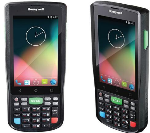
*Das ergonomisch gestaltete Industrie-Hybridgerät ScanPal EDA50K ist mit einem großzügigen Display ausgestattet und ermöglicht die Dateneingabe per Touchscreen oder Keypad. Es punktet mit guter Ablesbarkeit und hohem Bedienkomfort und passt dabei bequem in die Tasche.*
