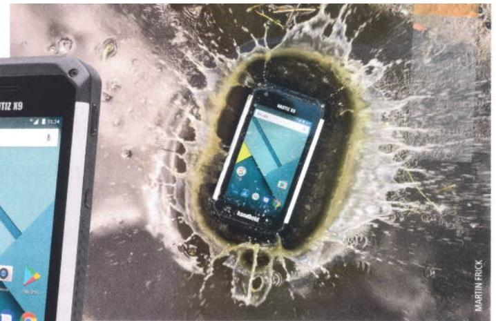
Der Mobilcomputer Nautiz 9 von Handheld läuft mit Android 7 und verfügt über ein 5"-Display mit kapazitivem Touch und Schutzklasse IP67.
