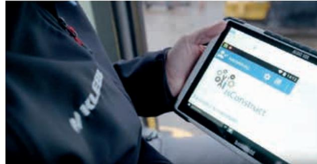
Hier setzt die speziell auf die Bedürfnisse der Baubranche zugeschnittene **isConstruct**-Lösung an. **isConstruct** ist eine Softwarelösung für mobile Datenerfassungsterminals. Damit können Bauunternehmen Ihre Maschinen, Geräte und Verbrauchsmaterialien im Blick behalten und kostenstellenbezogen verwalten.
