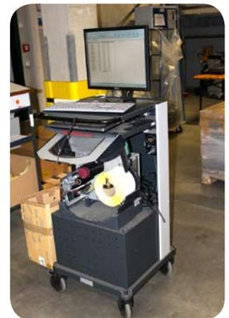
Mit der isWorkstation von Integer Solutions steht ein kompletter Arbeitsplatz genau dort zur Verfügung, wo er benötigt wird. Alle wichtigen IT-Komponenten an Bord - mit eigener Stromversorgung.
