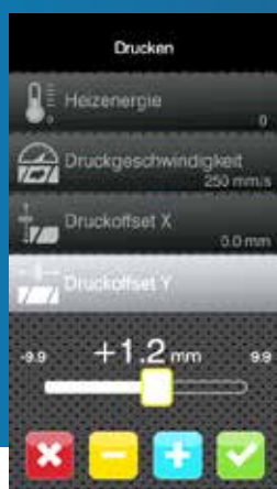
Druckoffset Y Schieberegler zur Schnelleinstellung, ± Tasten zur Feineinstellung
