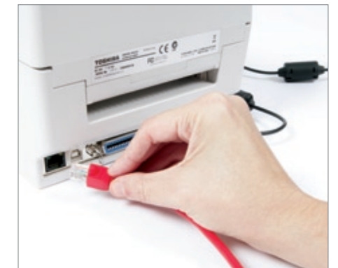
Eingebaute Netzwerkkarte mit 10/100Mbps LAN Interface
