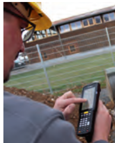
Die robusten Mobilcomputer laufen mit Android Betriebssystem und können wie ein herkömmliches Smartphone genutzt werden. Die Workforce Connect App
